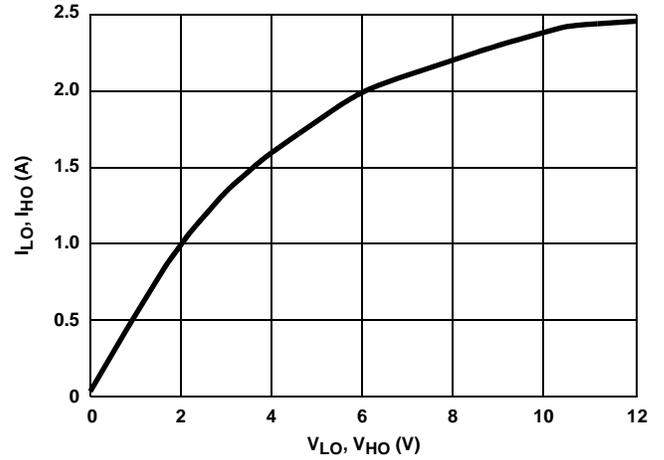
FIGURE 13. PEAK PULLDOWN CURRENT vs OUTPUT VOLTAGE
