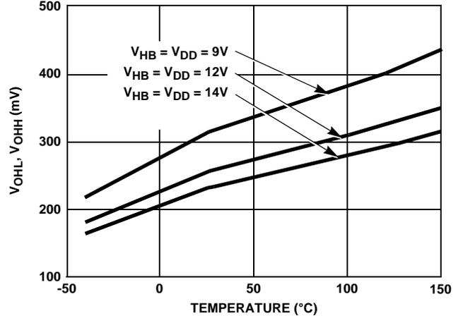
FIGURE 7. HIGH LEVEL OUTPUT VOLTAGE vs TEMPERATURE
