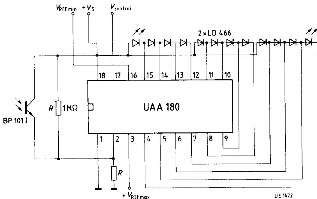
$R = 2.2\text{k}\Omega \dots 100\text{k}\Omega$
