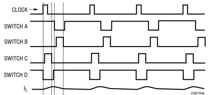
(4b) Buck-Boost Mode ( $V_{IN} \leq V_{OUT}$ )
