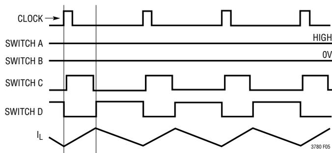
Figure 5. Boost Mode ( $V_{\text{IN}} < V_{\text{OUT}}$ )
