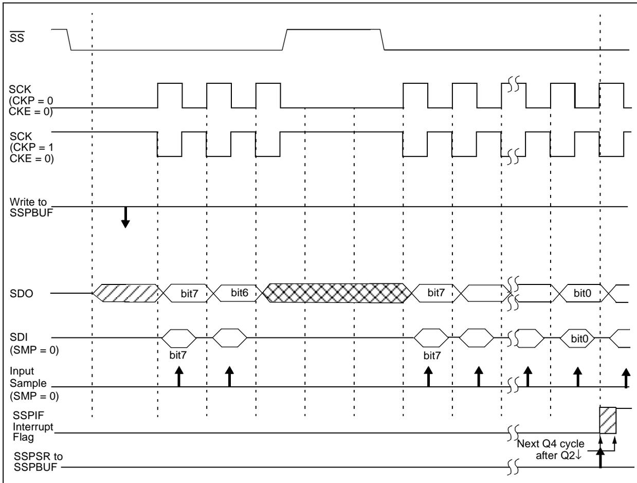
**FIGURE 15-8: SPI MODE WAVEFORM (SLAVE MODE WITH CKE = 0)**
