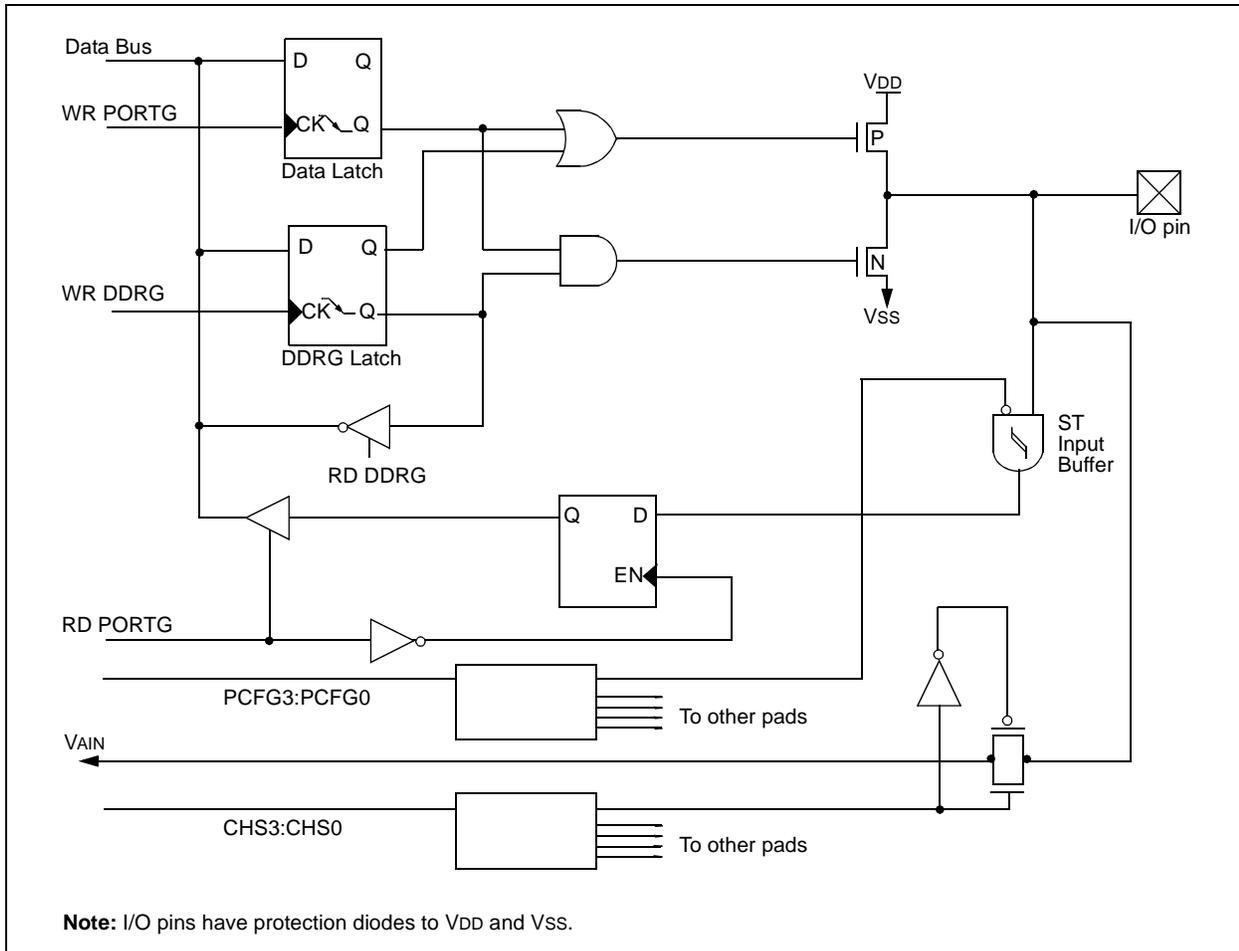
**FIGURE 10-15: RG4 BLOCK DIAGRAM**
