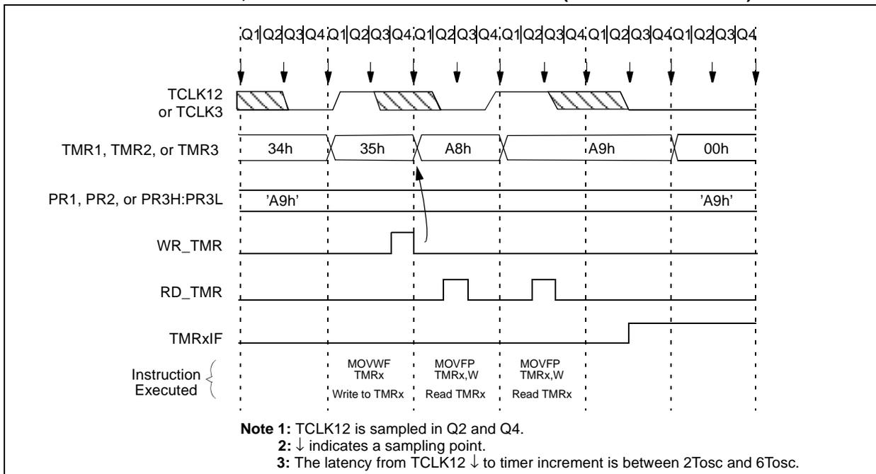
**FIGURE 13-8: TIMER1, TIMER2 AND TIMER3 OPERATION (IN TIMER MODE)**
