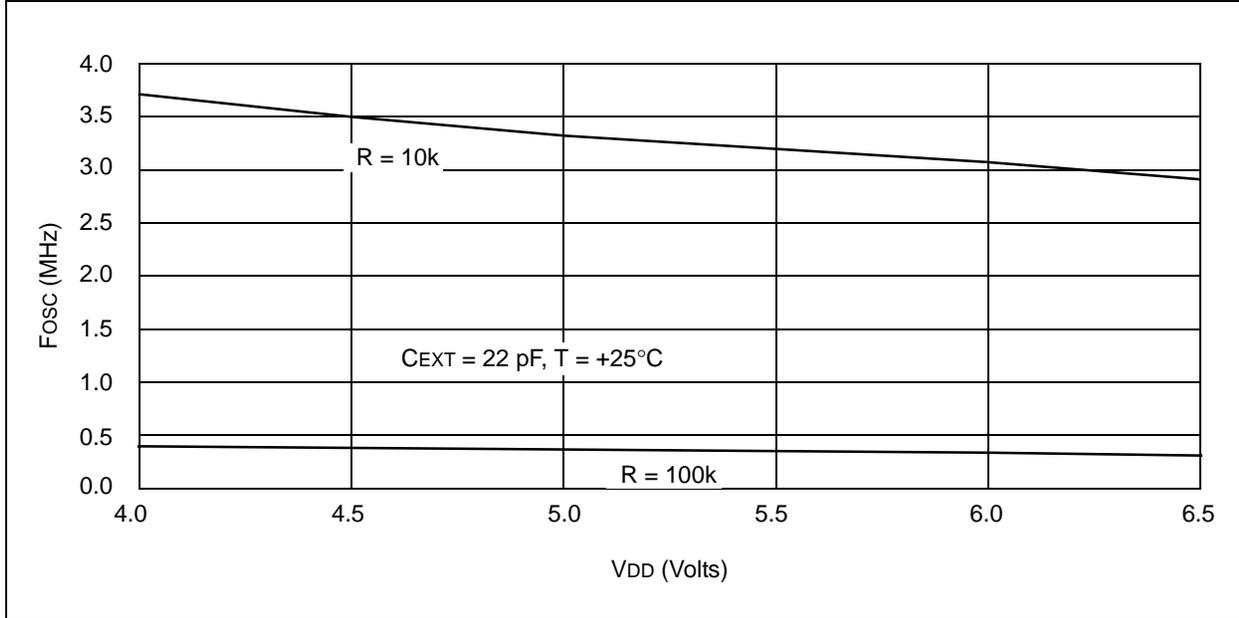
FIGURE 21-3: TYPICAL RC OSCILLATOR FREQUENCY vs. VDD
