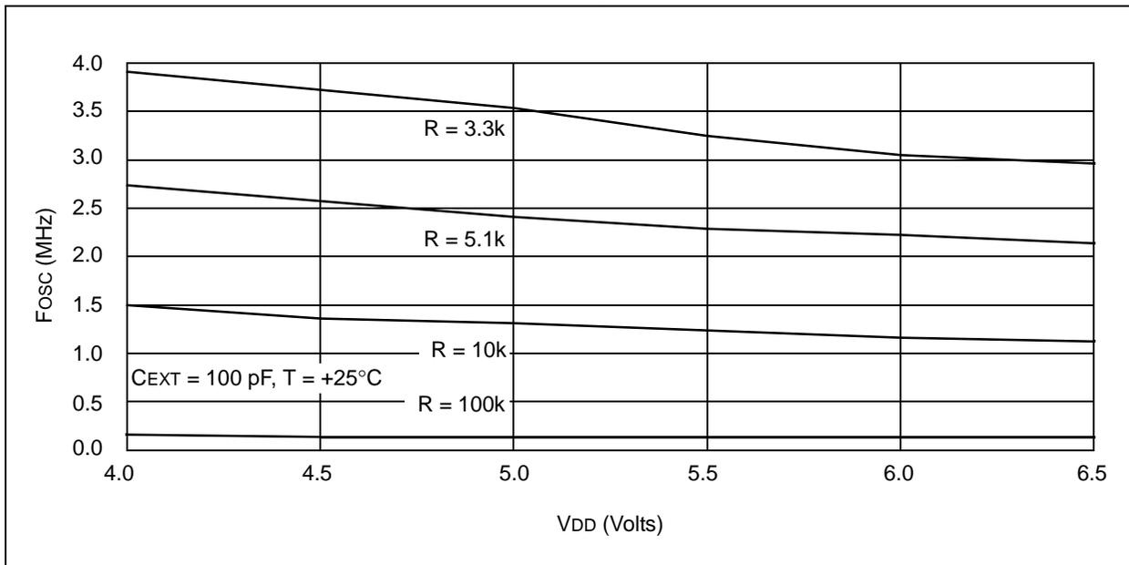
**FIGURE 21-4: TYPICAL RC OSCILLATOR FREQUENCY vs. V<sub>DD</sub>**
