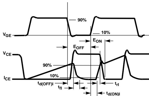
FIGURE 20. SWITCHING TEST WAVEFORMS
