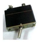
Автоматы предназначены для работы в стационарных и передвижных установках и служат для автоматического отключения потребителей электроэнергии при перегрузках и коротких замыканиях в цепях постоянного тока при напряжении до 30В.
