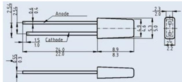
Фотодиоды КДФ115А с р-п переходом изготовлены на основе высокоомного кремния.
