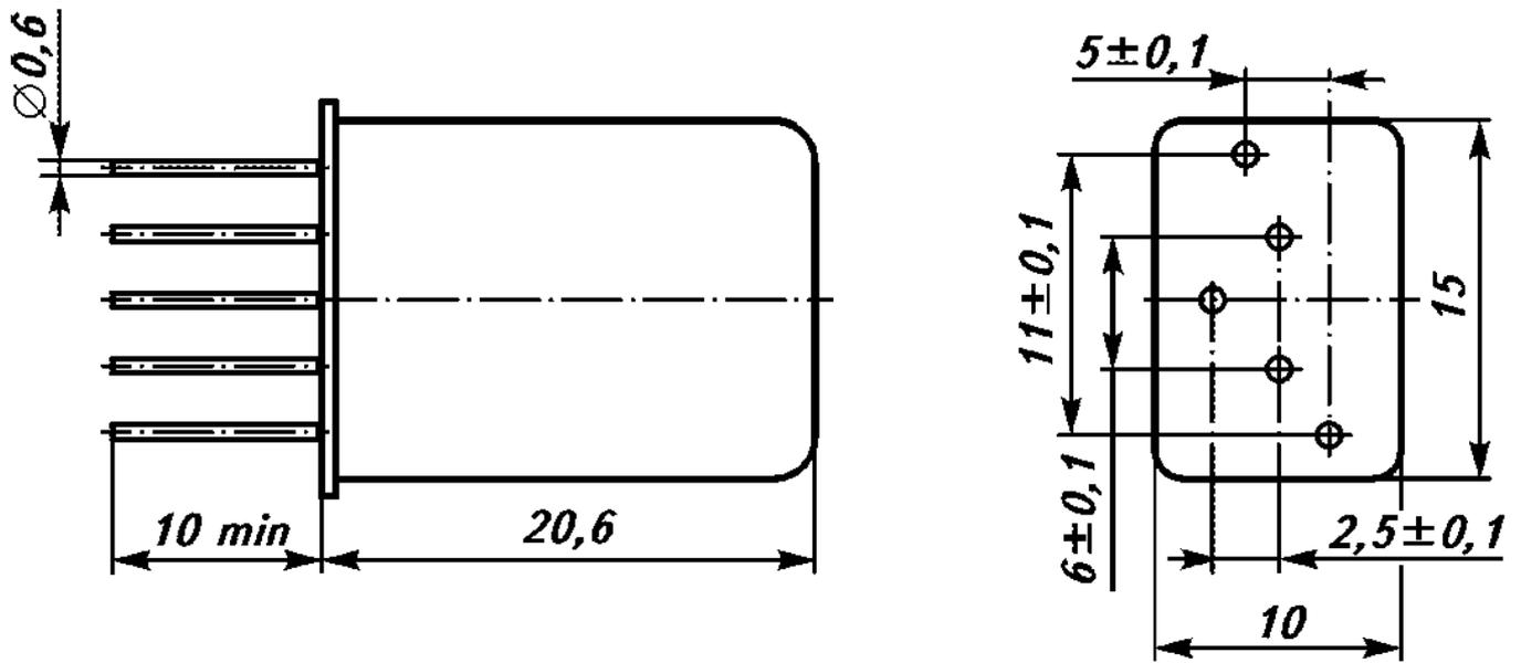
Общий вид, габаритные и установочные размеры электромагнитного реле ТКН21П1ДГ
