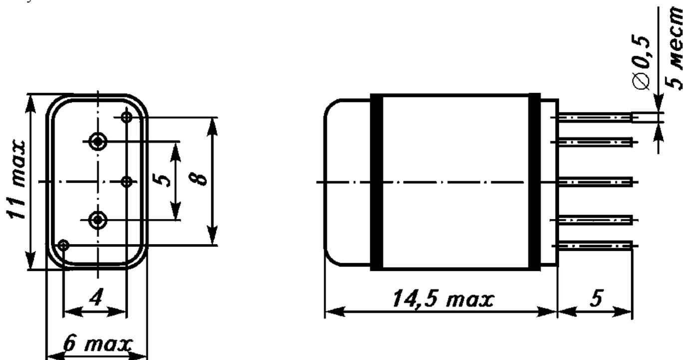
Общий вид, габаритные и установочные размеры электромагнитного реле ТКН21ПОДГМ 2 серия
