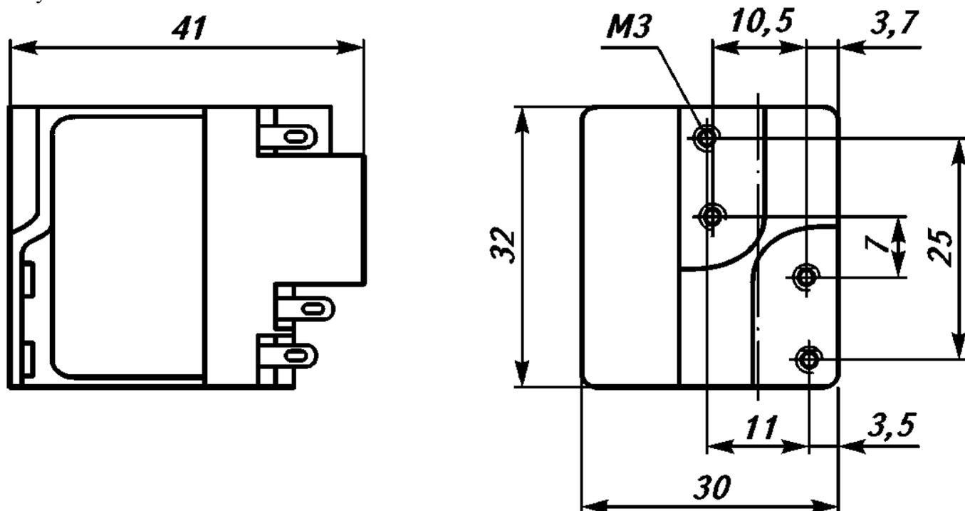
Общий вид, габаритные и установочные размеры электромагнитных реле ТПЕ22ПОДГБ и СПЕ22ПОДГБ
