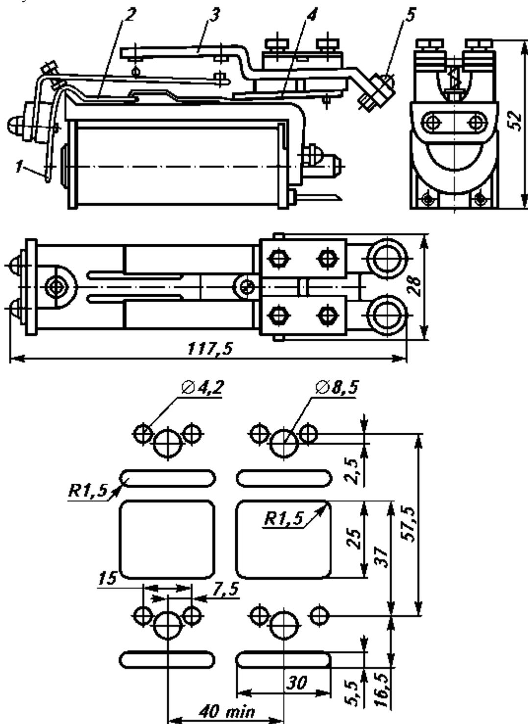
Общий вид, габаритные и установочные размеры электромагнитного реле ТКЕ22П1ГБ
