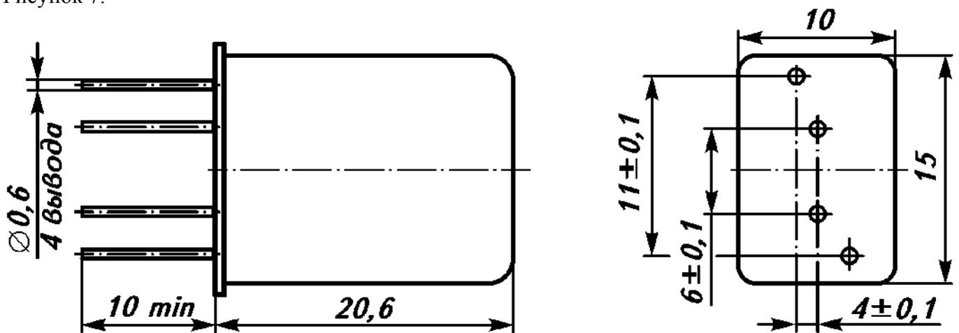
Общий вид, габаритные и установочные размеры электромагнитного реле ТКЕ101ОДГ
