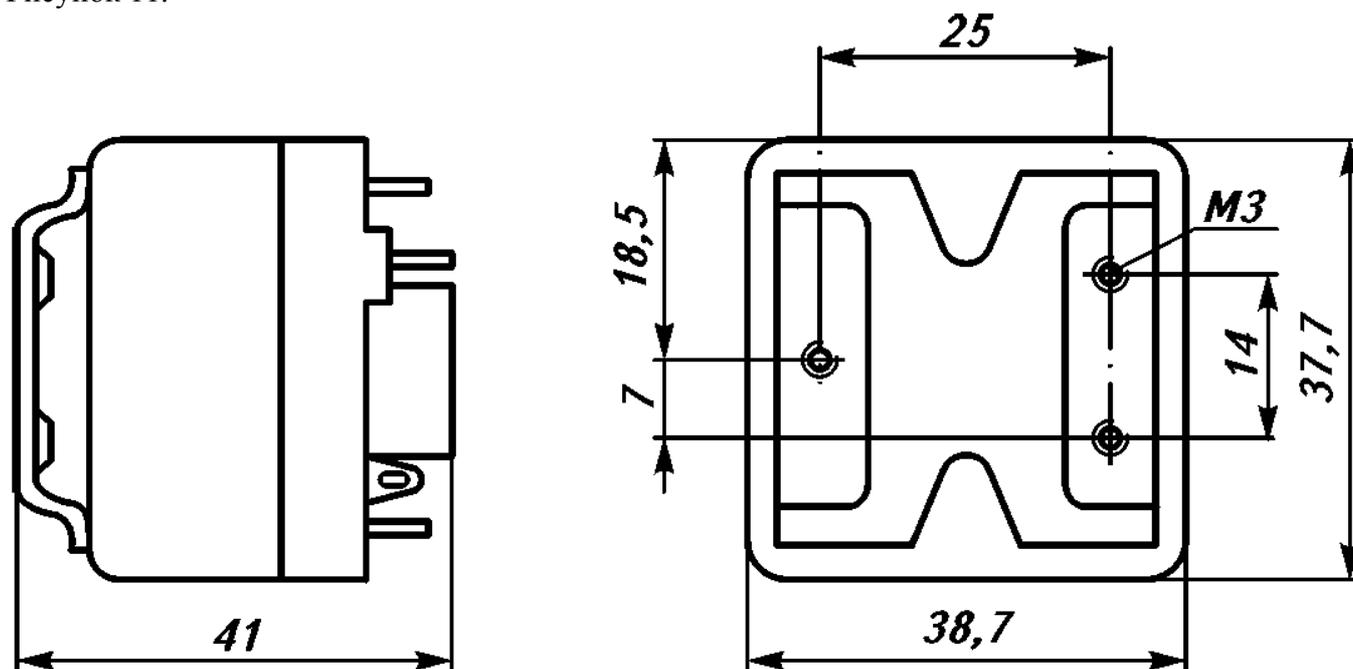
Общий вид, габаритные и установочные размеры электромагнитного реле ТКЕ26П1ГБ
