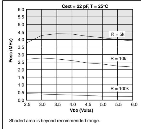
**FIGURE 14-6: TYPICAL RC OSCILLATOR FREQUENCY vs.  $V_{DD}$**
