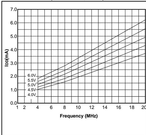
**FIGURE 14-30: MAXIMUM I<sub>DD</sub> vs. FREQUENCY
