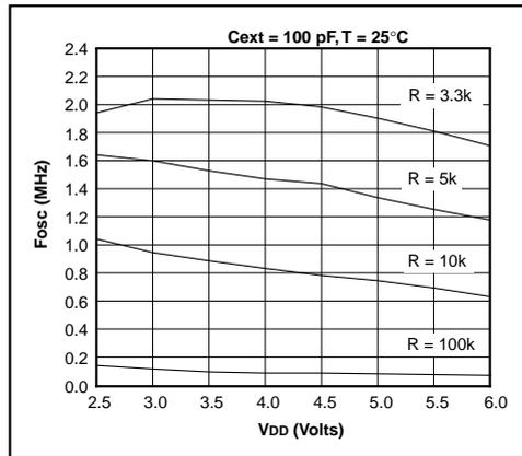
**FIGURE 14-7: TYPICAL RC OSCILLATOR FREQUENCY vs.  $V_{DD}$**
