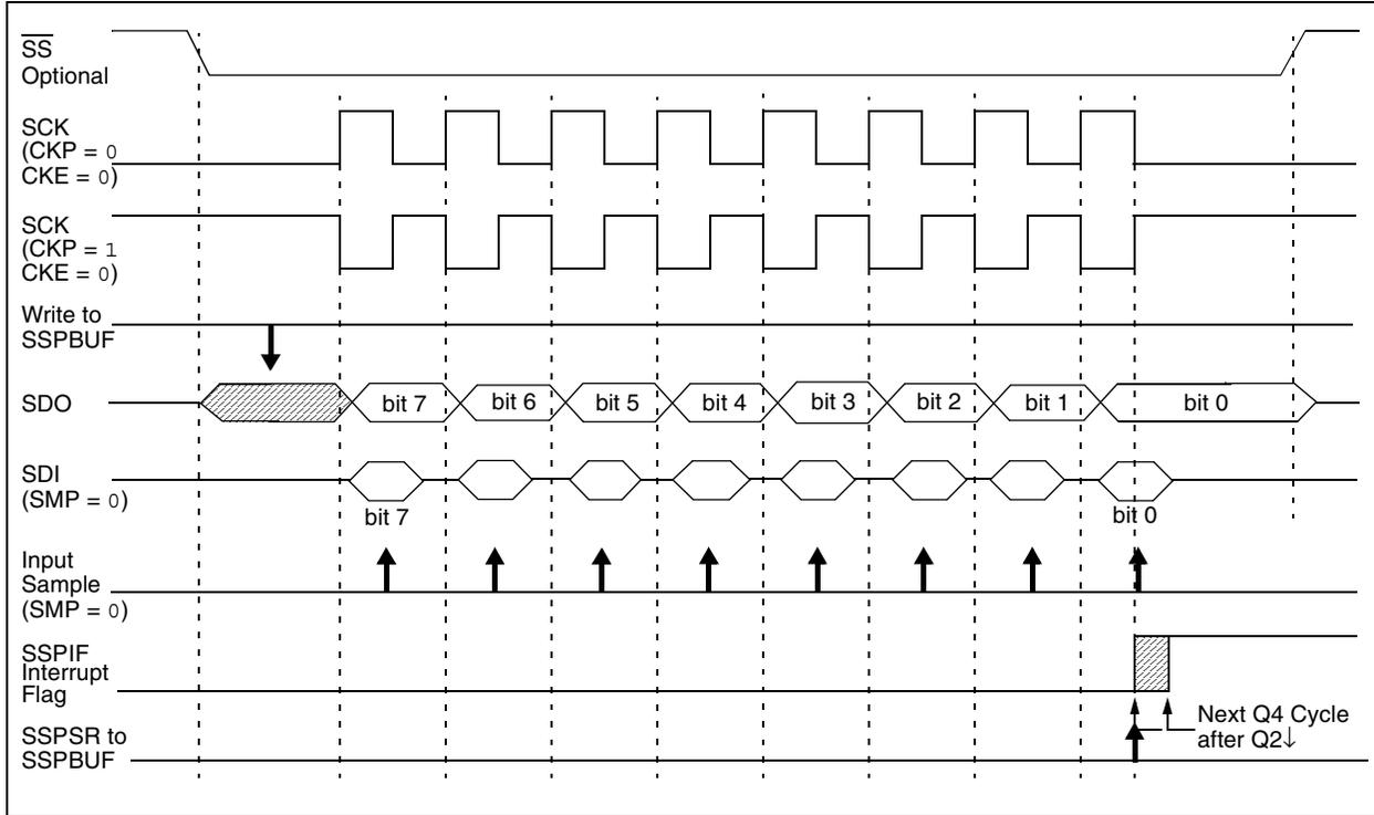
**FIGURE 16-6: SPI MODE WAVEFORM (SLAVE MODE WITH CKE = 1)**
