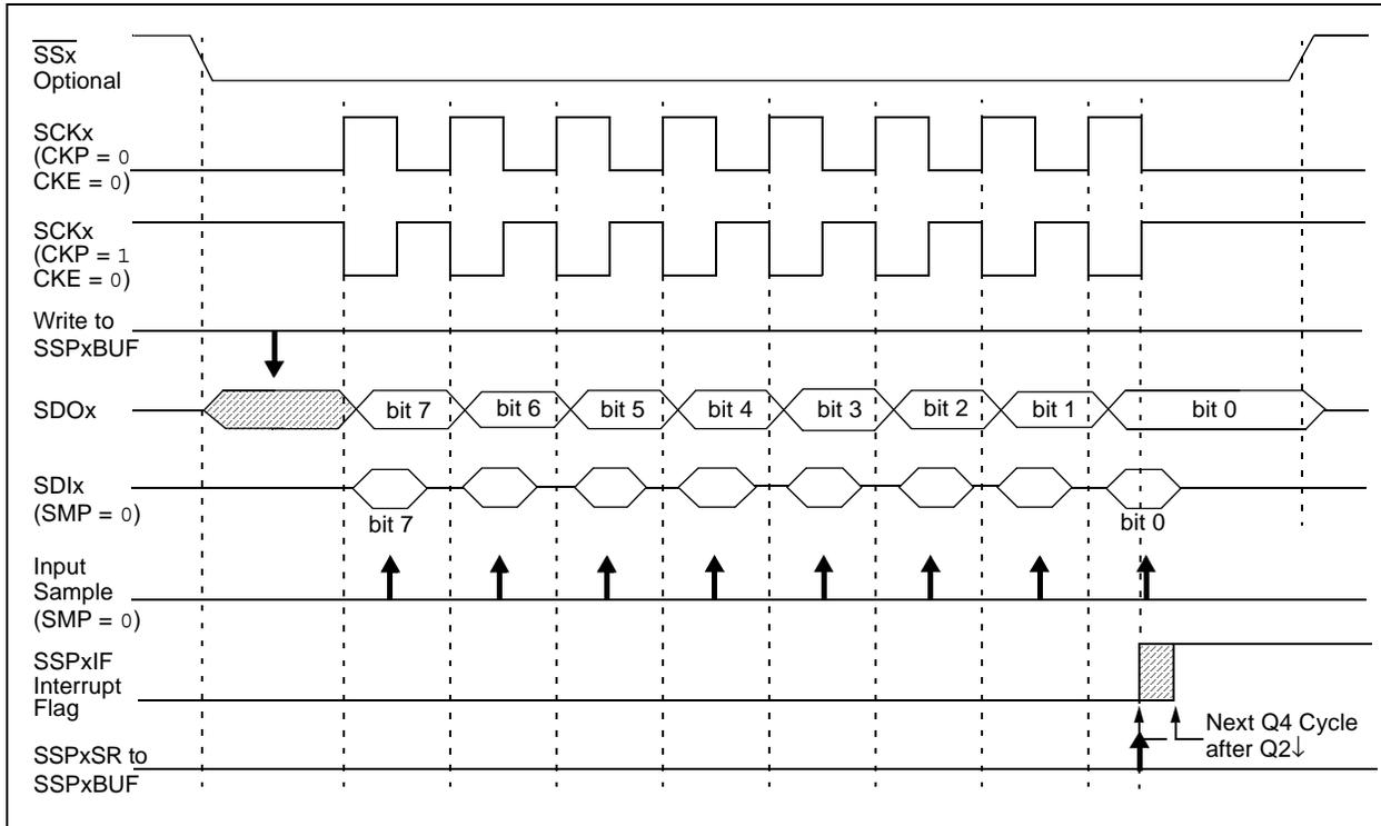
**FIGURE 19-6: SPI™ MODE WAVEFORM (SLAVE MODE WITH CKE = 1)**
