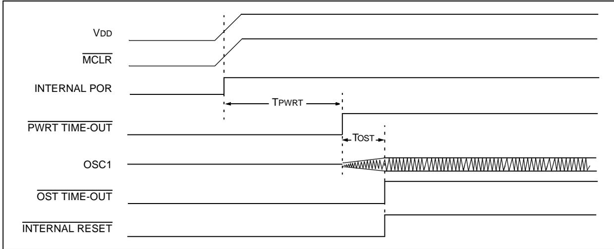
**FIGURE 4-4: TIME-OUT SEQUENCE ON POWER-UP ( $\overline{\text{MCLR}}$  RISES BEFORE  $T_{\text{OST}}$  COMPLETES)**
