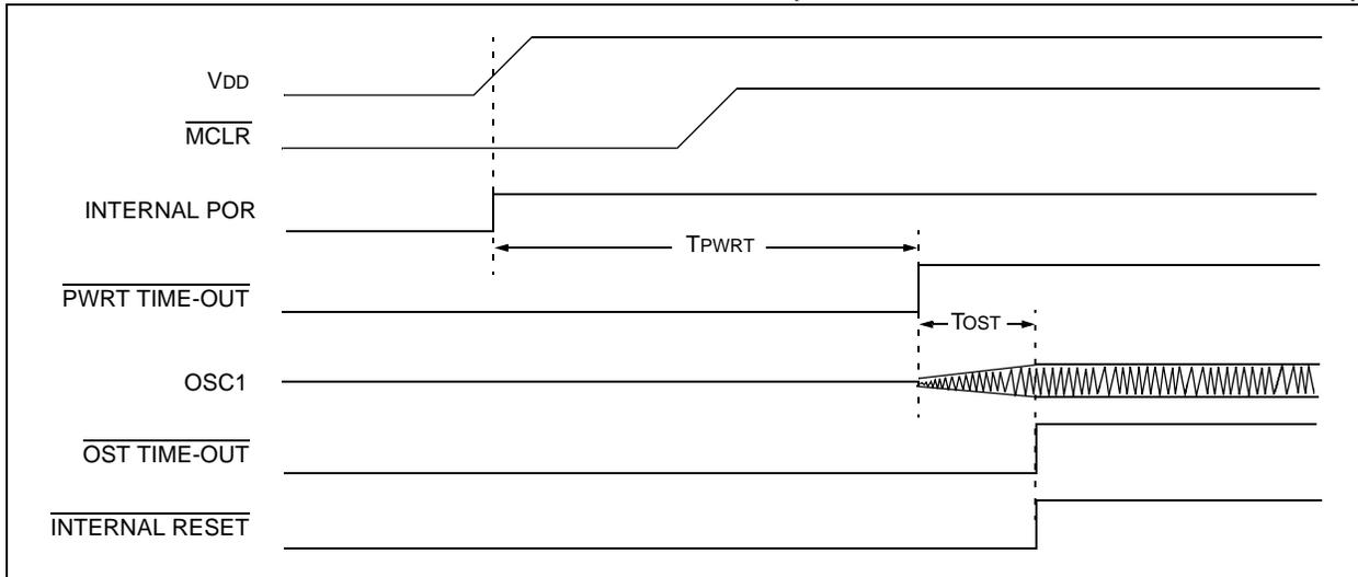
**FIGURE 4-5: TIME-OUT SEQUENCE ON POWER-UP ( $\overline{\text{MCLR}}$  RISES AFTER  $T_{\text{OST}}$  COMPLETES)**
