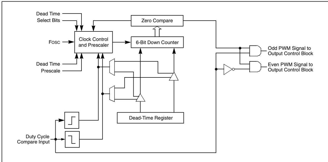
**FIGURE 13-18: DEAD-TIME INSERTION FOR COMPLEMENTARY PWM**
