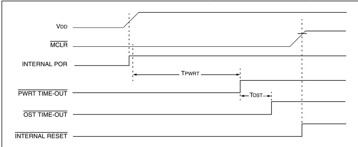
**FIGURE 4-6: SLOW RISE TIME ( $\overline{\text{MCLR}}$  TIED TO  $V_{\text{DD}}$ ,  $V_{\text{DD}}$  RISE  $>$   $T_{\text{PWRT}}$ )**
