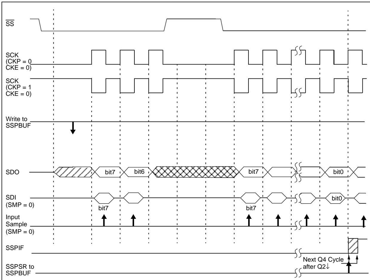
**FIGURE 15-4: SPI MODE WAVEFORM (SLAVE MODE WITH CKE = 0)**
