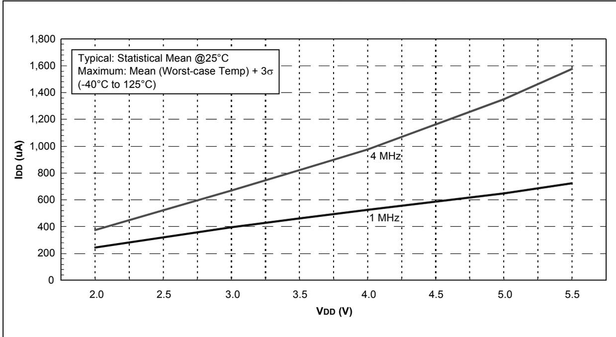
FIGURE 18-7: TYPICAL I<sub>DD</sub> vs. V<sub>DD</sub> OVER F<sub>osc</sub> (EXTRC MODE)
