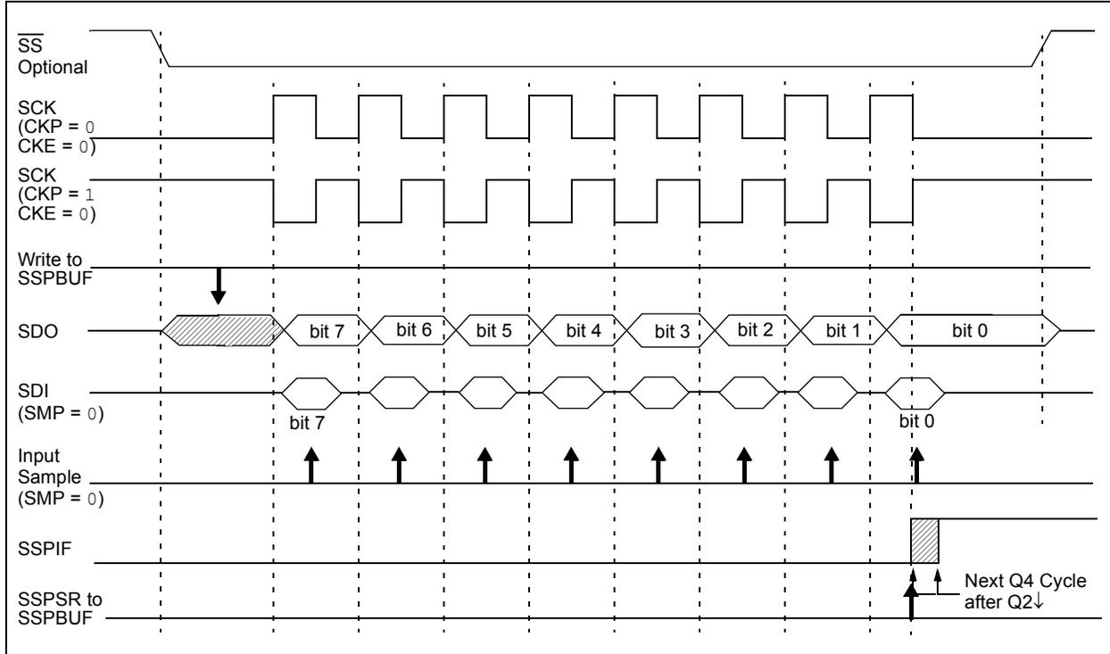
**FIGURE 13-5: SPI MODE WAVEFORM (SLAVE MODE WITH CKE = 1)**
