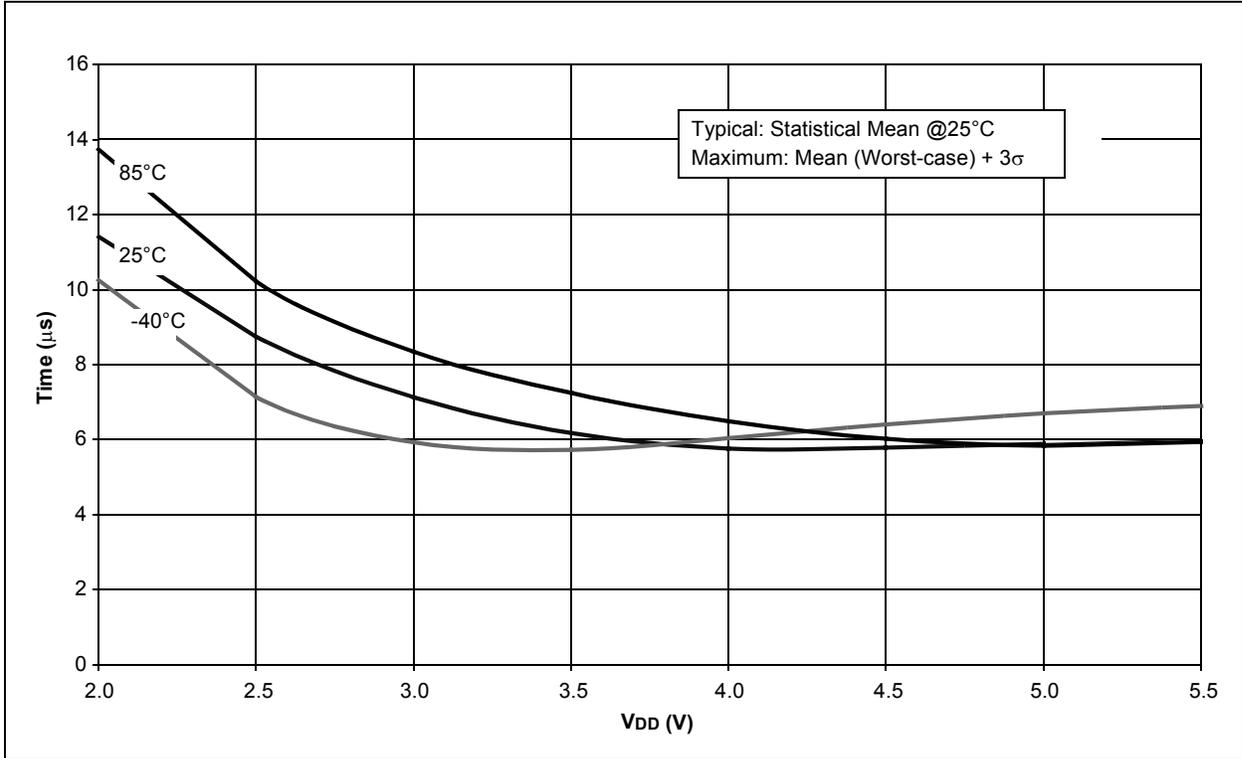
FIGURE 18-37: MAXIMUM HFINTOSC START-UP TIMES vs. V<sub>DD</sub> OVER TEMPERATURE
