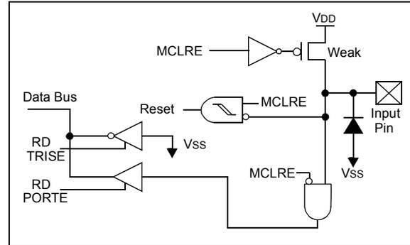
**FIGURE 3-21: BLOCK DIAGRAM OF RE<2:0>**
