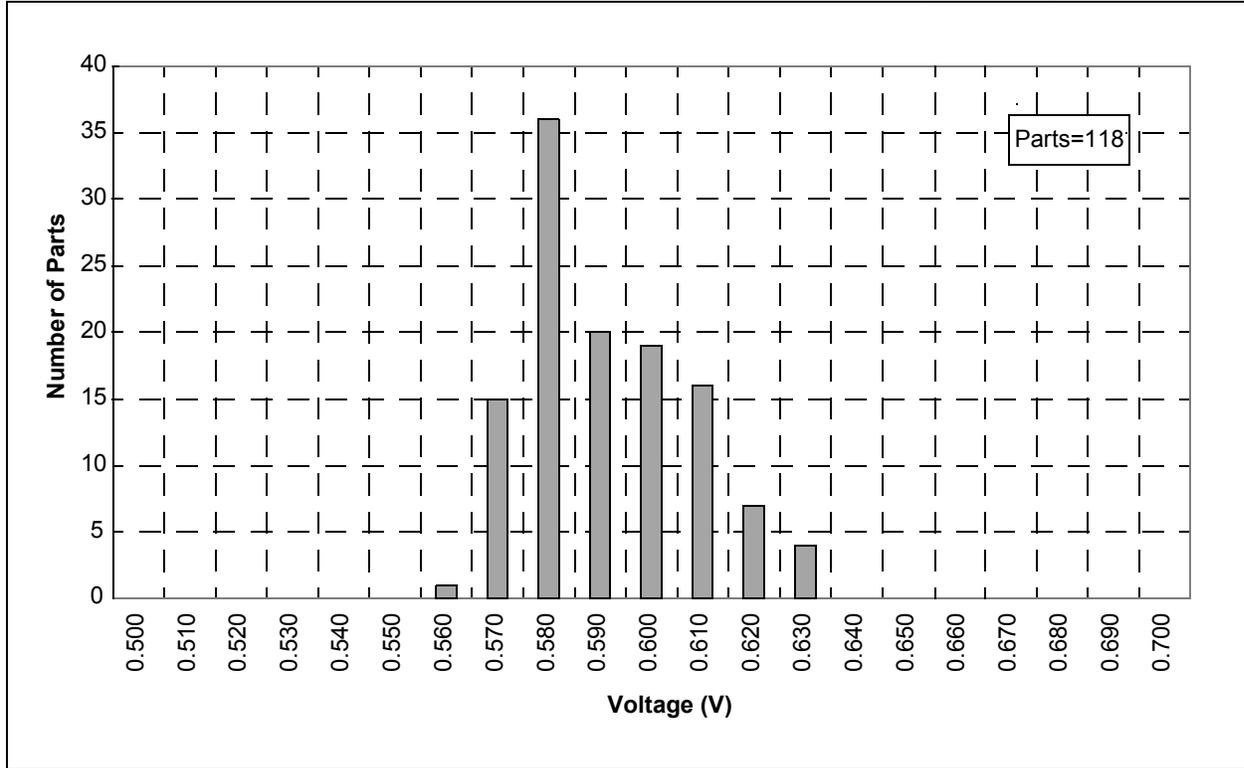
FIGURE 18-49: TYPICAL VP6 REFERENCE VOLTAGE DISTRIBUTION (3V, -40°C)
