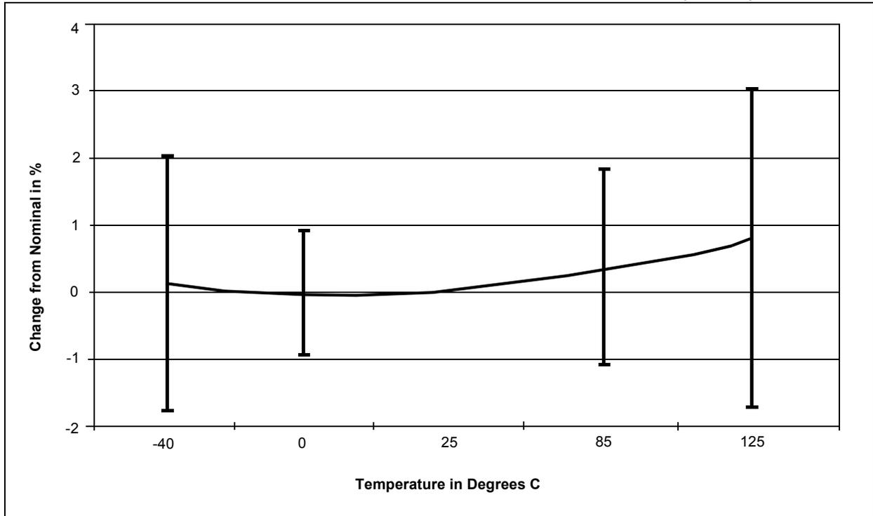
FIGURE 18-45: VP6 DRIFT OVER TEMPERATURE NORMALIZED AT 25°C (V<sub>DD</sub> 3V)
