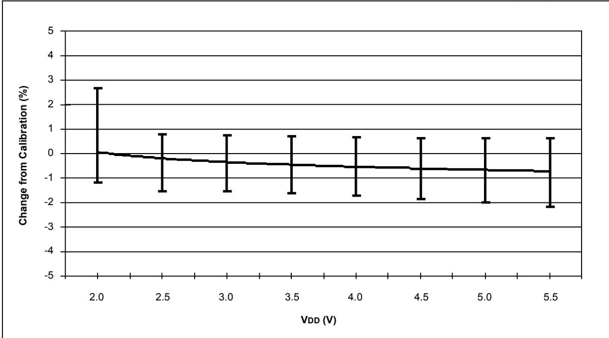
FIGURE 18-41: TYPICAL HFINTOSC FREQUENCY CHANGE vs. V<sub>DD</sub> (125°C)
