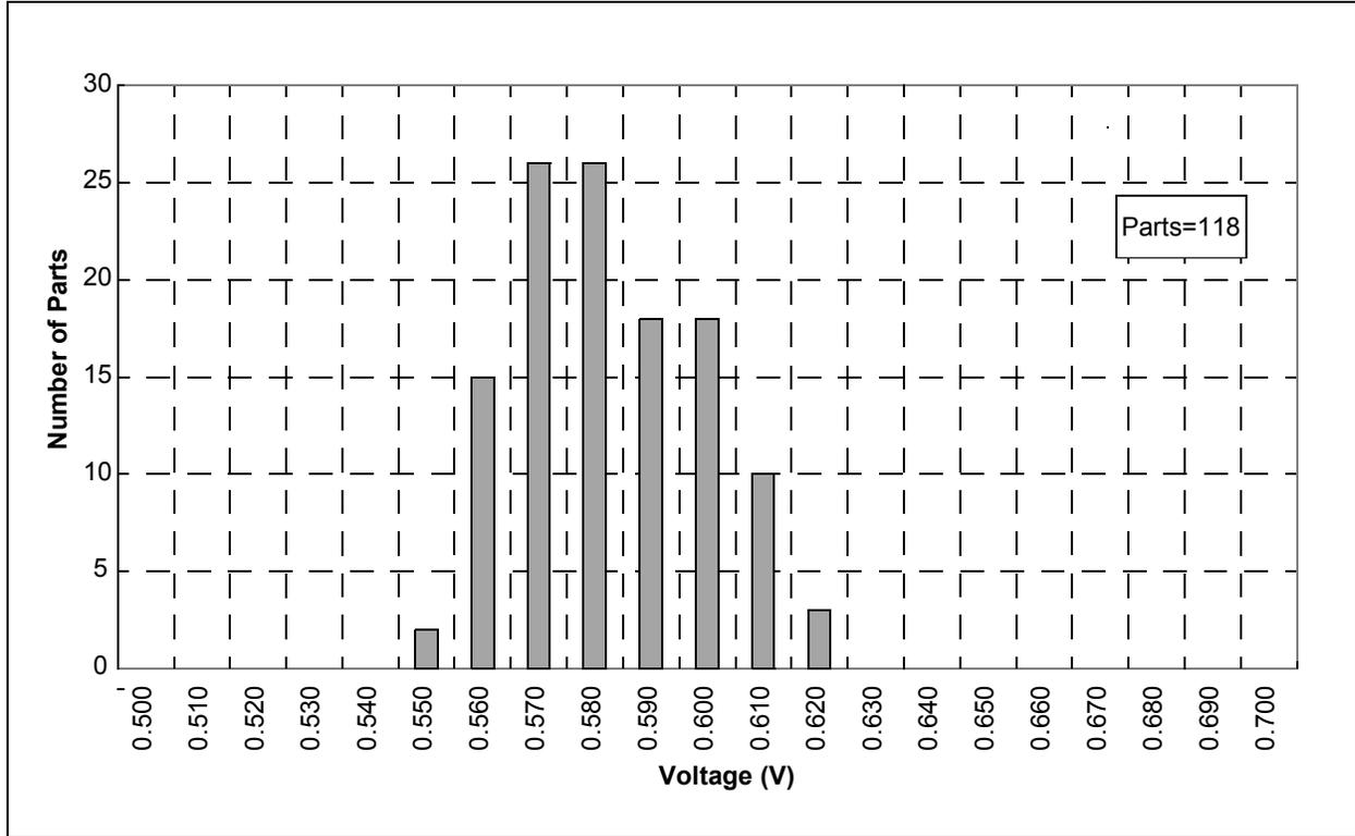
FIGURE 18-53: TYPICAL VP6 REFERENCE VOLTAGE DISTRIBUTION (5V, -40°C)
