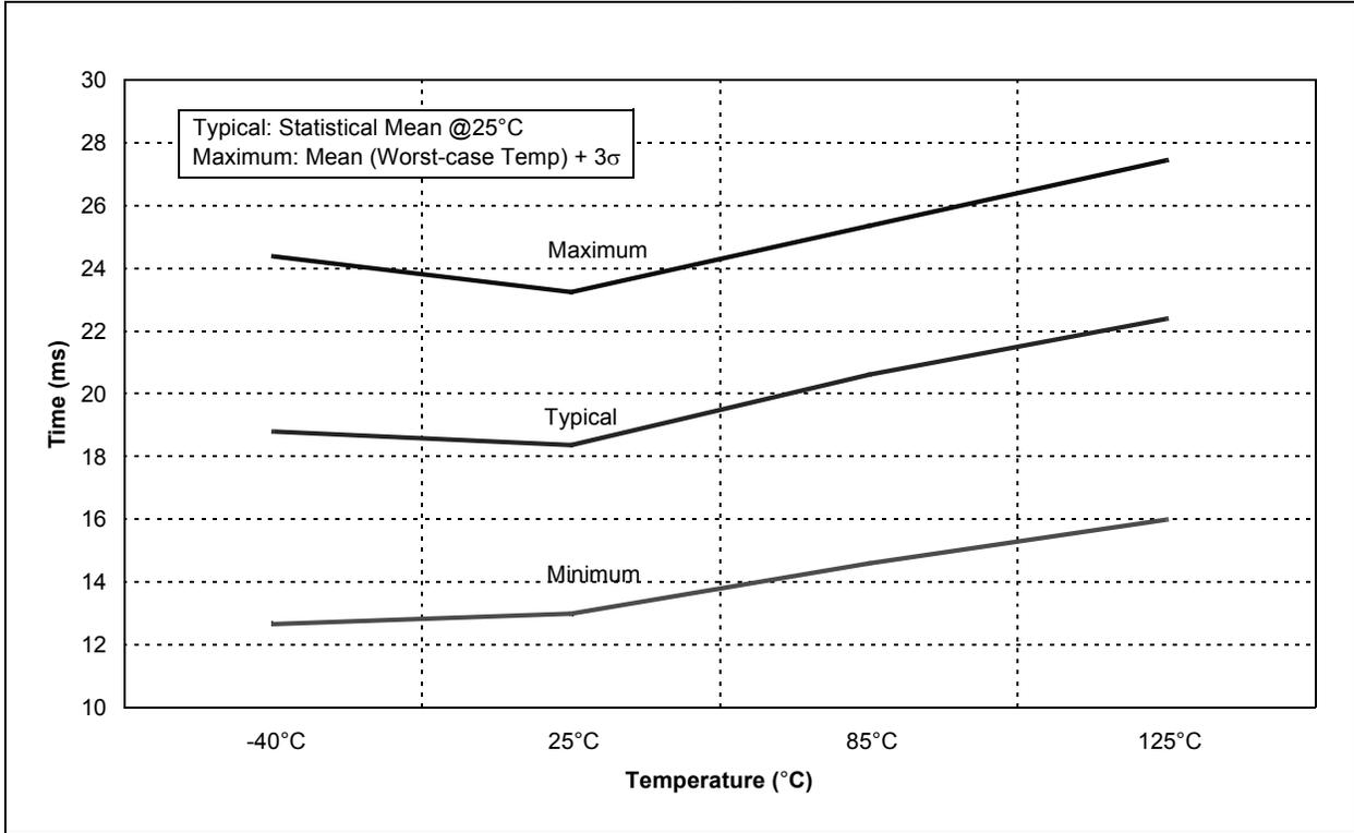
FIGURE 18-21: CVREF IPD vs. V<sub>DD</sub> OVER TEMPERATURE (HIGH RANGE)
