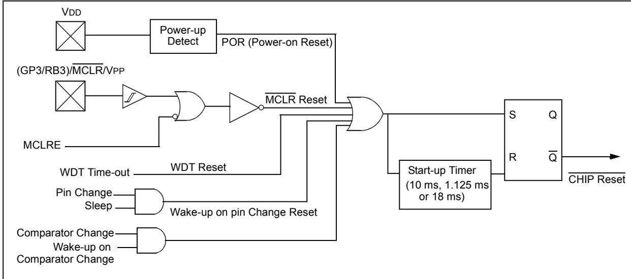
**FIGURE 10-8: TIME-OUT SEQUENCE ON POWER-UP ( $\overline{\text{MCLR}}$  PULLED LOW)**
