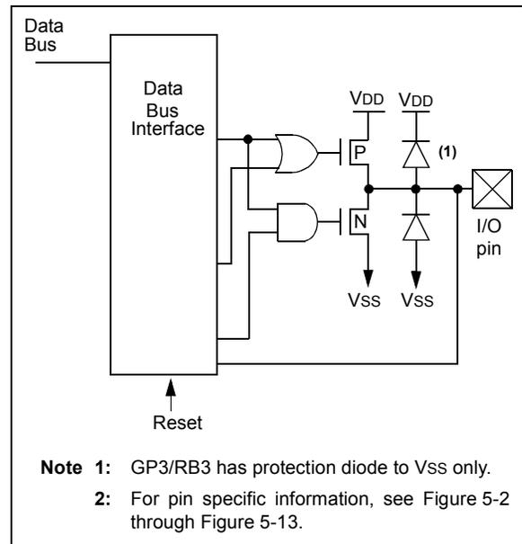
**FIGURE 5-4: BLOCK DIAGRAM OF GP2**
