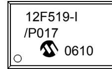
8-Lead SOIC (3.90 mm)
