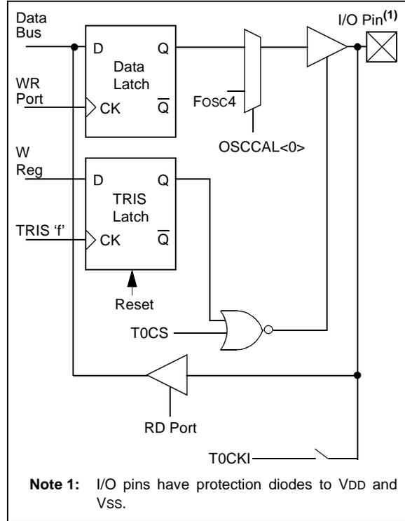
**FIGURE 5-4: BLOCK DIAGRAM OF GP3**
