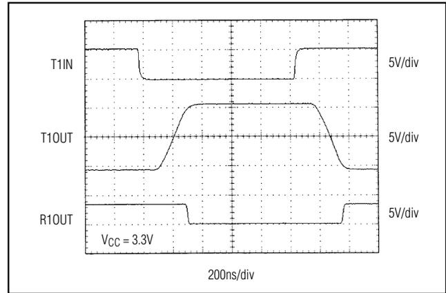
Figure 10. MAX3225/MAX3227/MAX3245 Loopback Test Result at 1Mbps
