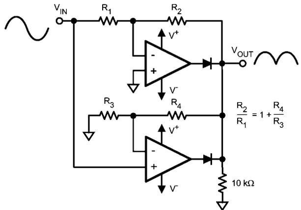
FIGURE 9. Precision Rectifier
