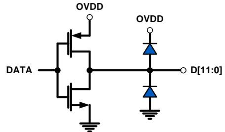
FIGURE 47. CMOS OUTPUTS
