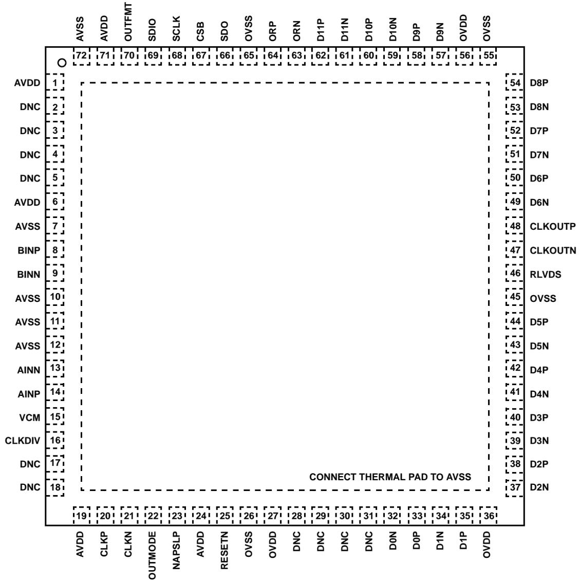
FIGURE 3. PIN CONFIGURATION
