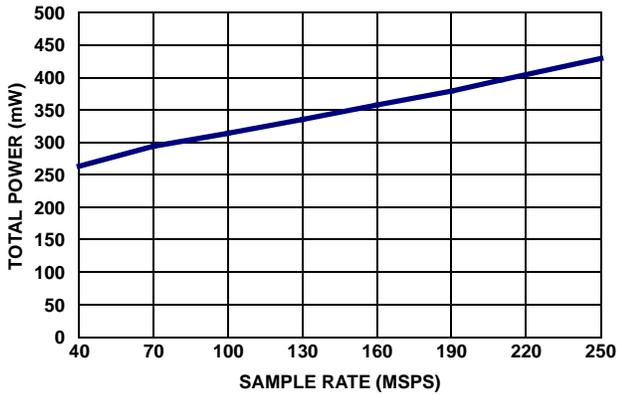
FIGURE 10. POWER vs f<sub>SAMPLE</sub> IN 3mA LVDS MODE
