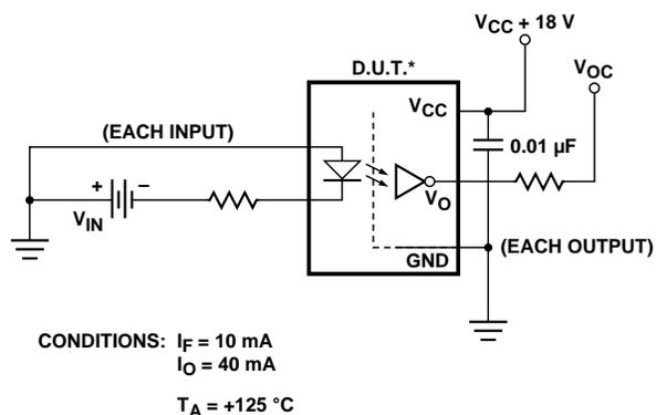
\* ALL CHANNELS TESTED SIMULTANEOUSLY.
