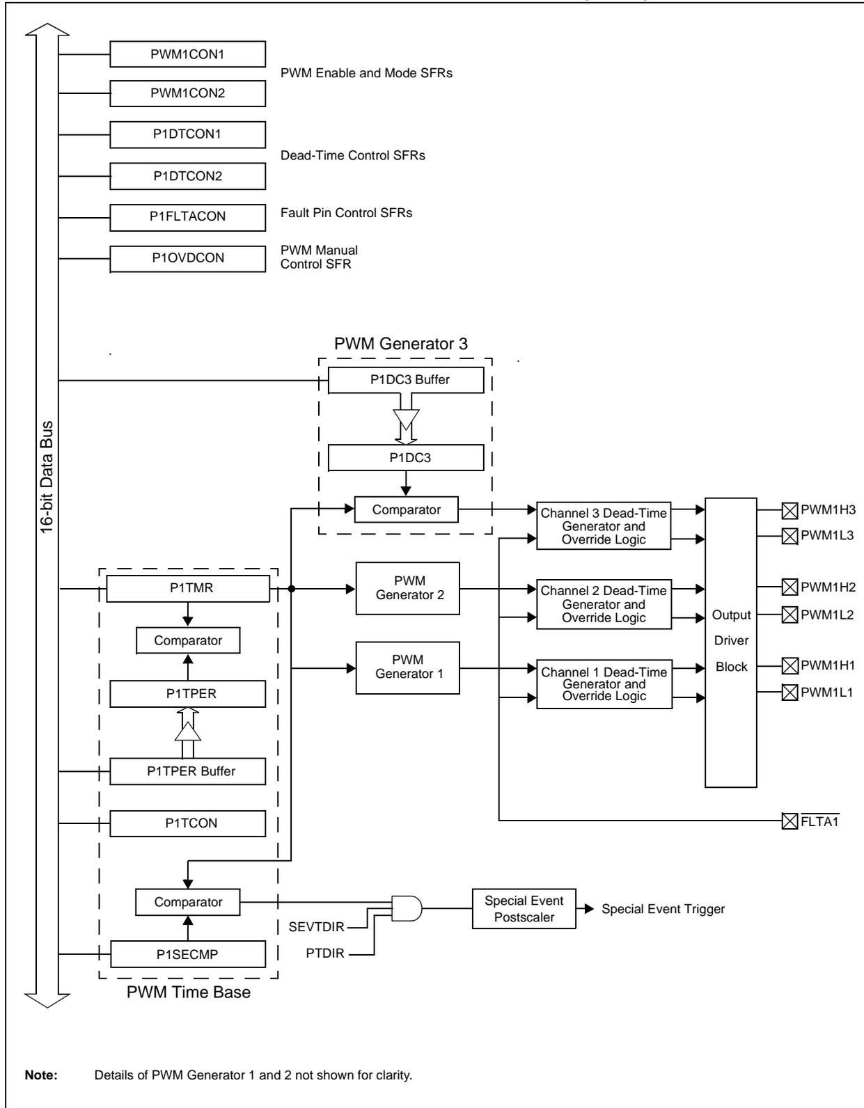
**FIGURE 14-2: 2-CHANNEL PWM MODULE BLOCK DIAGRAM (PWM2)**
