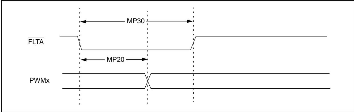
**FIGURE 23-11: MOTOR CONTROL PWM MODULE TIMING CHARACTERISTICS**
