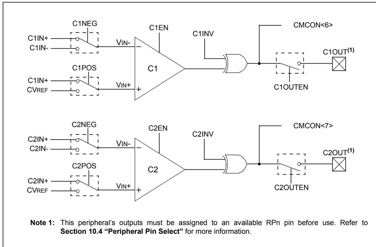
**REGISTER 23-1: CMCON: COMPARATOR CONTROL REGISTER**
