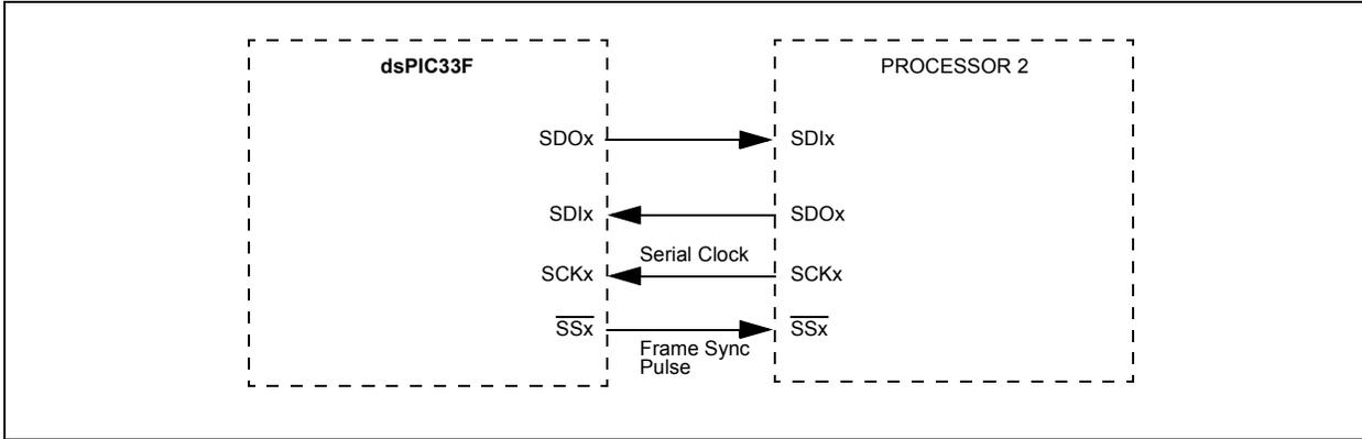
**FIGURE 17-6: SPI SLAVE, FRAME SLAVE CONNECTION DIAGRAM**
