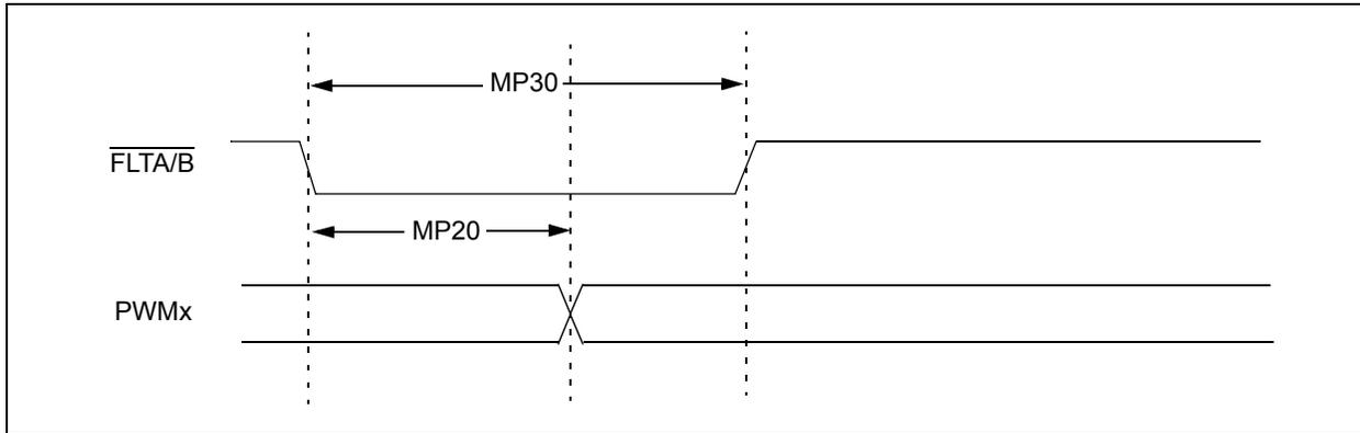
**FIGURE 25-11: MOTOR CONTROL PWM MODULE TIMING CHARACTERISTICS**
