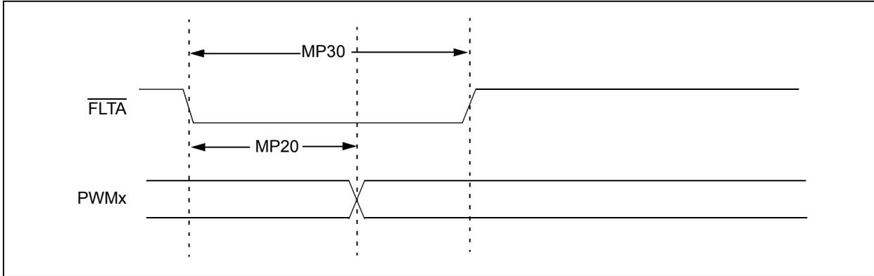
**FIGURE 24-13: MOTOR CONTROL PWM MODULE TIMING CHARACTERISTICS**
