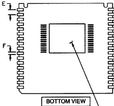
**NOTE:** DALLAS SEMICONDUCTOR RECOMMENDS THAT POWERCAP MODULE BASES EXPERIENCE ONE PASS THROUGH SOLDER REFLOW ORIENTED WITH THE LABEL SIDE UP ("LIVE-BUG").
