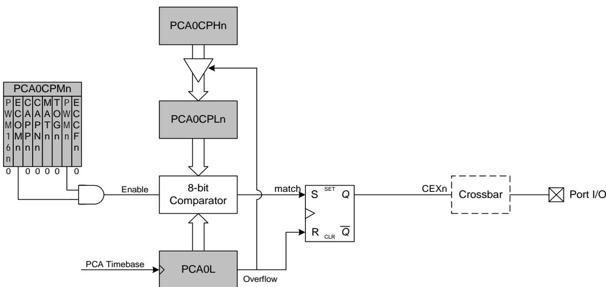
Figure 20.8. PCA 8-Bit PWM Mode Diagram
