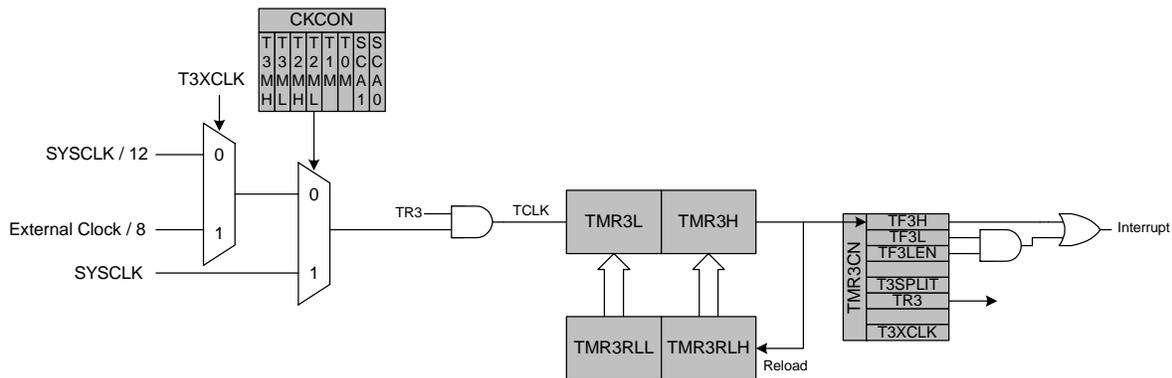
**Figure 22.6. Timer 3 16-Bit Mode Block Diagram**
