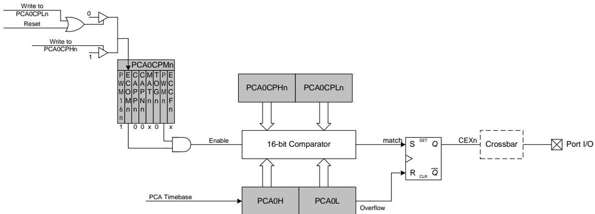
Figure 16.9. PCA 16-Bit PWM Mode
