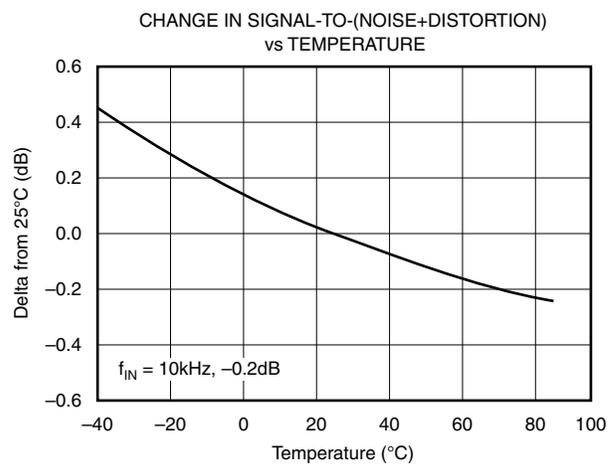
**TYPICAL CHARACTERISTICS,  $V_{CC} = 2.7 V$**
