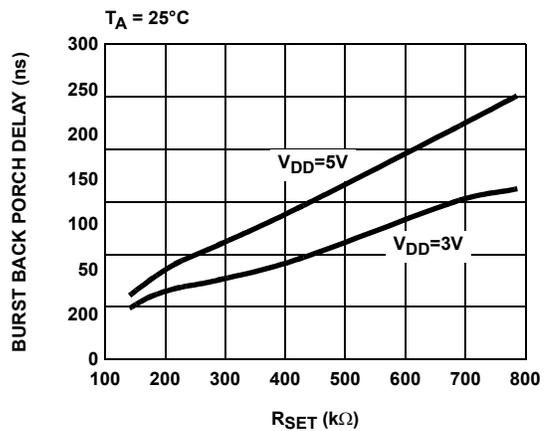
FIGURE 2. BURST/BACK PORCH DELAY vs R<sub>SET</sub>
