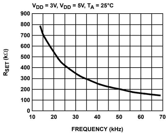
FIGURE 1. R<sub>SET</sub> vs HORIZONTAL FREQUENCY
