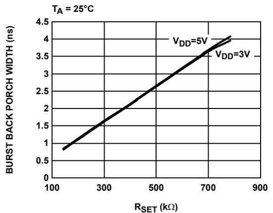
FIGURE 4. BURST/BACK PORCH WIDTH vs R<sub>SET</sub>
