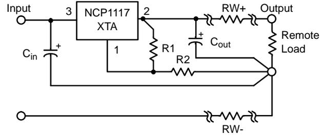
**Figure 23. Load Sensing**
