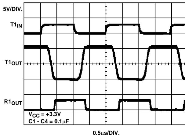
FIGURE 14. LOOPBACK TEST AT 1Mbps ( $C_L = 250\text{pF}$ )
