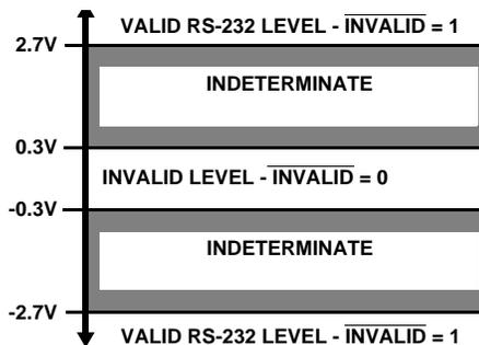
FIGURE 6. DEFINITION OF VALID RS-232 RECEIVER LEVELS
