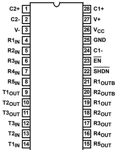
ICL3243E (SOIC, SSOP, TSSOP)
