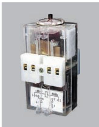
Предназначены для сигнализации аварийного состояния в цепях постоянного тока напряжением до 220 В, переменного тока напряжением до 380 В частотой 50 Гц и напряжением до 440 В частотой 60 Гц и применяются в устройствах автоматики. В зависимости от количества и видов контактов реле изготавливаются в типоразмерах, приведенных в таблице. Реле с контактом с самовозвратом изготавливаются только для постоянного тока.
