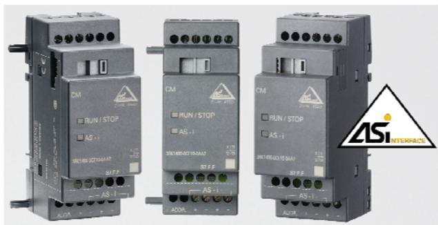
Коммуникационный модуль LOGO! CM AS-i выполняет функции ведомого устройства AS-Interface и поддерживает 4 виртуальных дискретных входа и 4 виртуальных дискретных выхода. Он и способен передавать информацию о состоянии 4 дискретных входов LOGO! ведущему устройству AS-Interface, а также принимать от него 4 управляющих дискретных сигнала.
