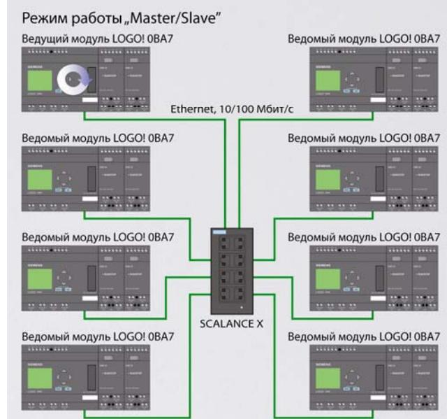
Программу выполняет только ведущий логический модуль. Ведомые модули собственной программы не имеют и выполняют функции блоков расширения ведущего логического модуля. За счет этого ведущий логический модуль способен обслуживать до 64 дискретных входов, до 64 дискретных выходов, до 32 аналоговых входов и до 16 аналоговых выходов.
