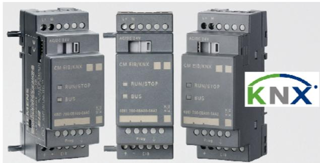
Коммуникационный модуль LOGO! CM EIB/KNX позволяет использовать логические модули LOGO! 0BA6/0BA7 в режиме ведущих устройств сети EIB/KNX. Эта сеть находит применение в системах автоматизации зданий. В сети KNX модуль LOGO! CM EIB/KNX позволяет опрашивать до 16 дискретных и до 8 аналоговых датчиков, а также управлять работой до 12 дискретных и до 2 аналоговых исполнительных устройств.
