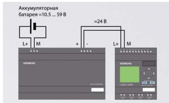
тареей и логическим модулем, обеспечивая сохранение работоспособности системы управления при различных уровнях напряжения аккумуляторной батареи.
