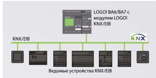
модуля LOGO! CM EIB/KNX в сочетании с другими модулями расширения количество датчиков и исполнительных устройств, подключаемых через сеть KNX, снижается. Например, при использовании модуля LOGO! CM EIB/KNX в сочетании с модулем LOGO! DM8 через сеть KNX может быть подключено не более 12 дискретных датчиков и не более 8 дискретных исполнительных устройств.
