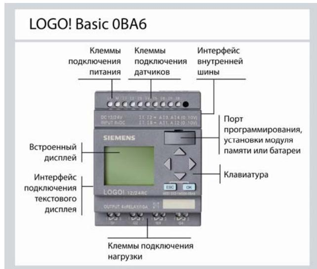
Логические модули LOGO! выпускаются в компактных пластиковых корпусах размерами 72x 90x 55 мм и имеют степень защиты IP 20. Каждый модуль оснащен:
