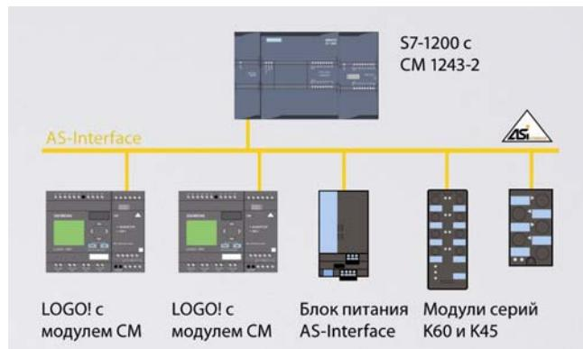
Применение модулей LOGO! CM AS-i позволяет выполнять согласованное функционирование нескольких модулей LOGO!, использовать входные сигналы одних модулей LOGO! для управления выходами другого модуля, использовать в работе модуля LOGO! сигналы, формируемые датчиками AS-Interface и т.д. При этом логические модули LOGO! могут быть разнесены на расстояние до 600 м, а функции согласования их работы выполняет ведущее устройство AS-Interface.
