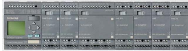
Наиболее простые устройства управления могут быть построены на основе одного логического модуля. Для построения более сложных устройств логический модуль дополняется необходимым набором модулей расширения. Обмен данными с большинством модулей расширения выполняется через внутреннюю шину логического модуля.
