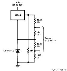
FIGURE 8. Fahrenheit Thermometer
