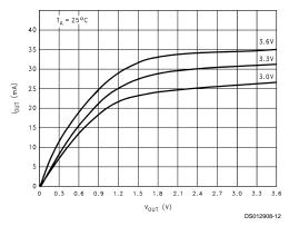
FIGURE 10.  $\rm I_{OL}$  vs  $\rm V_{OL}$
