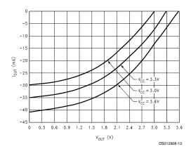
FIGURE 11.  $I_{OH}$  vs  $V_{OH}$
