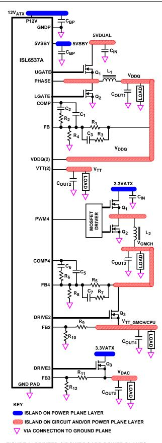
FIGURE 2. PRINTED CIRCUIT BOARD POWER PLANES AND ISLANDS
