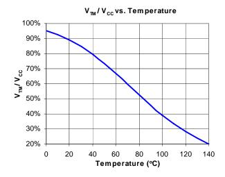
FIGURE 13. THE RATIO OF TM VOLTAGE TO NTC
