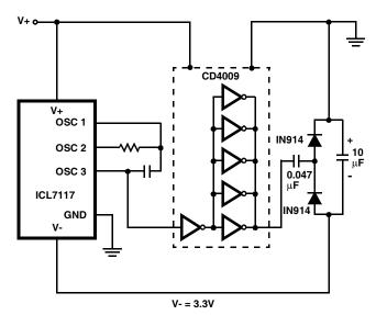
FIGURE 10. GENERATING NEGATIVE SUPPLY FROM +5V
