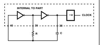
FIGURE 9B. RC OSCILLATOR FIGURE 9. CLOCK CIRCUITS
