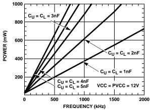
FIGURE 1. POWER DISSIPATION vs FREQUENCY
