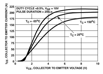
FIGURE 5. COLLECTOR TO EMITTER ON-STATE VOLTAGE
