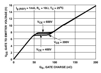
FIGURE 14. GATE CHARGE WAVEFORMS
