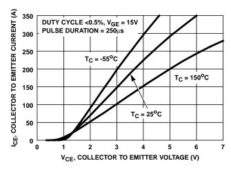
FIGURE 6. COLLECTOR TO EMITTER ON-STATE VOLTAGE
