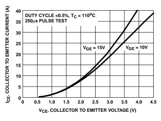
FIGURE 16. COLLECTOR TO EMITTER ON-STATE VOLTAGE
