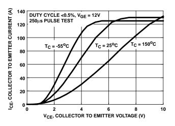
FIGURE 5. COLLECTOR TO EMITTER ON-STATE VOLTAGE
