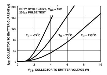
FIGURE 6. COLLECTOR TO EMITTER ON-STATE VOLTAGE
