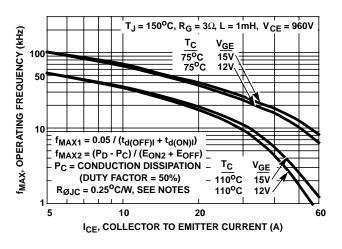
FIGURE 3. OPERATING FREQUENCY vs COLLECTOR TO EMITTER CURRENT
