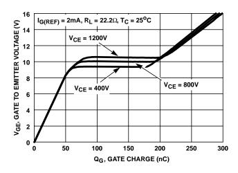
FIGURE 14. GATE CHARGE WAVEFORMS
