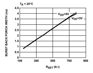
FIGURE 4. BURST/BACK PORCH WIDTH vs R<sub>SET</sub>
