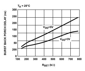
FIGURE 2. BURST/BACK PORCH DELAY vs R<sub>SET</sub>
