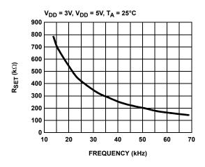
FIGURE 1.  $R_{\mbox{\scriptsize SET}}$  vs HORIZONTAL FREQUENCY
