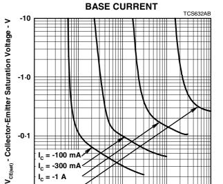
**COLLECTOR-EMITTER SATURATION VOLTAGE**
