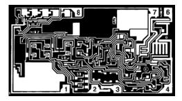
1. NULL 2. (-) INPUT 3. (+) INPUT 4. V-6. OUTPUT 7. V+ 8. NULL
