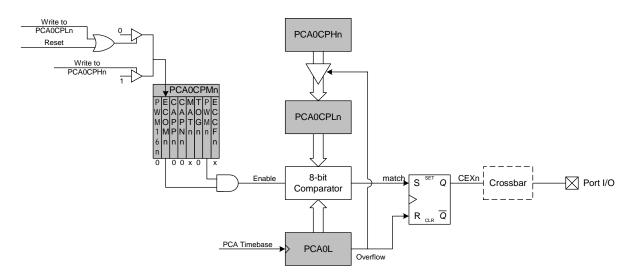
Figure 16.8. PCA 8-Bit PWM Mode Diagram
