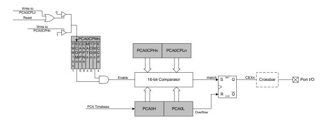
Figure 16.9. PCA 16-Bit PWM Mode
