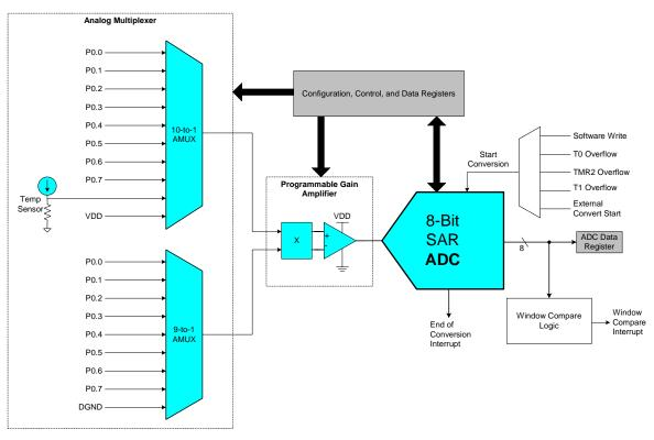
Figure 1.10. 8-Bit ADC Block Diagram
