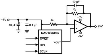
**FIGURE 9. Bipolar Operation**
